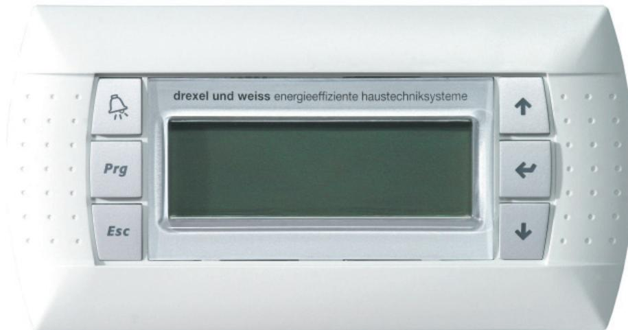
Das digitale Raumbediengerät arbeitet synchron zur Mikroprozessor-Steuerung am Lüftungsgerät. Die Menüführung, Tastenfunktion und der Funktionsumfang sind identisch.
