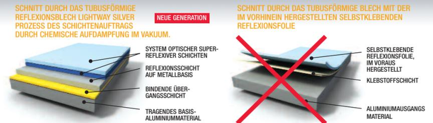
Dank einer einzigartigen Technologie, bei der mehrere optische sowie Schutzschichten auf chemischem Wege durch „Bedampfung“ im Vakuum direkt auf das tragende Aluminiumblech aufgetragen werden, entsteht eine homogene superreflektierende, elastische und mechanisch widerstandsfähige Oberfläche.
