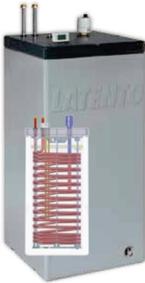
Unser Pufferspeicher zur Langzeitwärmespeicherung. Der XP weist einen großen Wärmetauscher aus langwelligem Edelstahlwellrohr für sehr guten Wärmeübertrag auf. Sein isolierender Kunststoffbehälter verliert praktisch keine Speicherwärme (0,1K/h). Latentmaterial sorgt für zusätzliche Leistungssteigerung. Speichertemperatur und Füllstand werden über ein digitales Display angezeigt.
