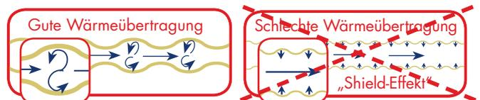
Alle Wärmetauscher sind aus langwelligem Edelstahlwellrohr für verbesserten Wärmeertrag. Dadurch entsteht kein „Shield-Effekt“ (Vorbeifließen) wie bei einem engwelligem Rohr.
